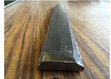
El talón debe ser lo suficientemente resistente para que el calor del arco logre fundirlo sin perforarlo al ejecutar la pasada de raíz. El soldeo de la pasada de raíz se hará con electrodos de 2,5. Es lo más difícil, pues exige la máxima concentración del soldador, un movimiento uniforme y un ángulo del electrodo que deberá mantenerse constante durante el soldeo.
