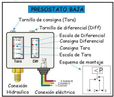
Como referencia para posicionar las escalas del presostato de baja: La presión de arranque a la cual ha de arrancar el compresor será la correspondiente a la temperatura que ha de haber en el recinto a enfriar para el refrigerante que estemos utilizando, si es superior el compresor no arrancará hasta que la temperatura del local no se eleve no garantizando una temperatura estable, esto es especialmente importante en los circuitos frigoríficos de congelación como cámaras frigoríficas.
