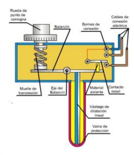
Dilatación de fluidos: Los detectores de dilatación de fluidos llevan un fuelle de dilatación que se rellena con un líquido de fuerte dilatación, como el alcohol, petróleo, aceite. Las variaciones de temperatura del fluido contenido en el fuelle causan la dilatación de todo el fuelle que produce la actuación de un microinterruptor.
