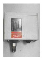
Los circuitos frigoríficos tienen que mantener sus valores de presión dentro de unos límites. Si éstos se sobrepasaran se podrían causar daños muy graves en el circuito. Los presostatos son dispositivos que controlan la presión del fluido en el punto donde estén conectados, accionando un contacto eléctrico (todo-nada) con el cual se realizará una maniobra determinada según los casos.
